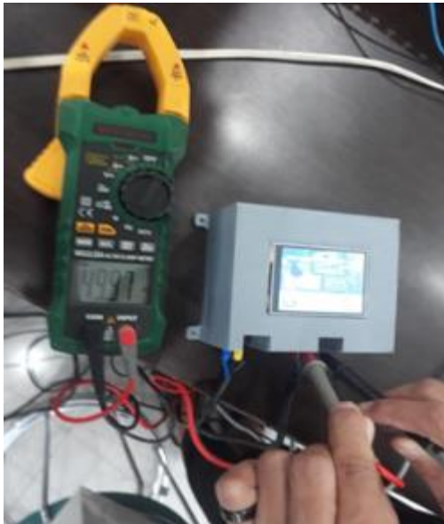
Gambar 9 Pengukuran secara langsung dengan tang ampere
